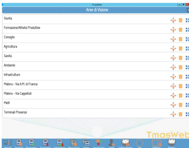
A seguito dell'acquisizione dei nuovi dispositivi di controllo accessi (vedi paragrafo successivo), è stata installata una nuova versione del software di gestione dei terminali di rilevazione presenze/accessi in ambiente Web. Tramite questa versione, i terminali, collegati su rete TCP, vengono gestiti integralmente nella programmazione, acquisizione timbrature, sincronizzazione
