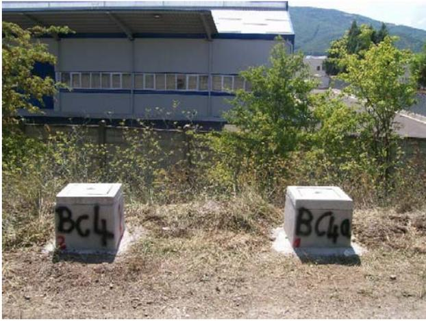
**Fig. 4** -Piezometri attrezzati con chiusini
