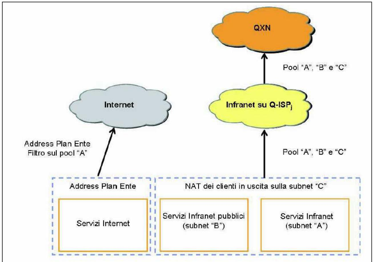
Figura 2.7: Piano di indirizzamento SPC
