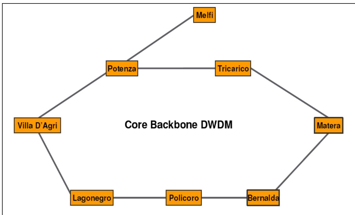
Figura 2.2: Schema topologico della rete (core-backbone ottico)
