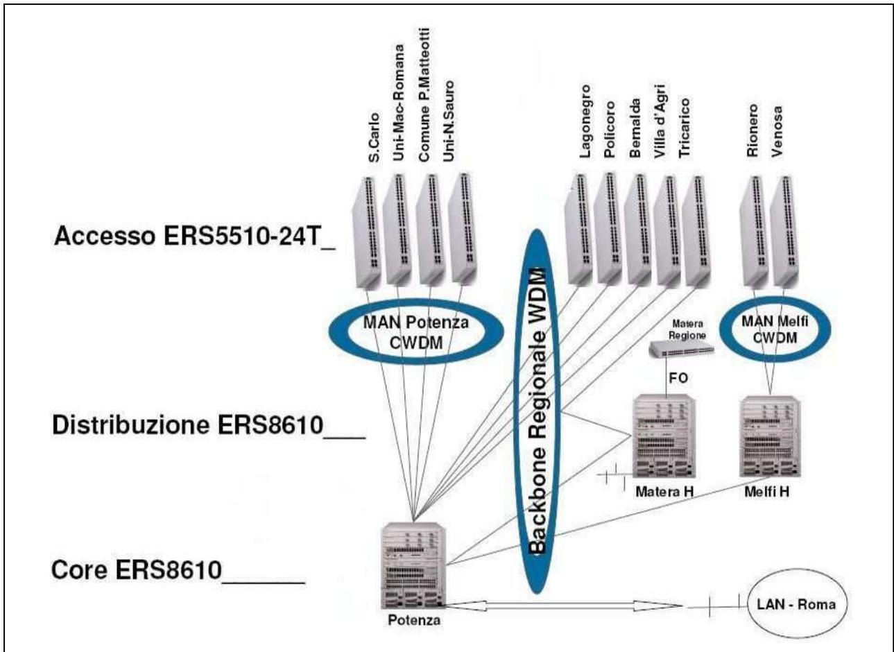
Figura 2.4: Struttura logica di accesso ai servizi IP permanente della Regione Basilicata
