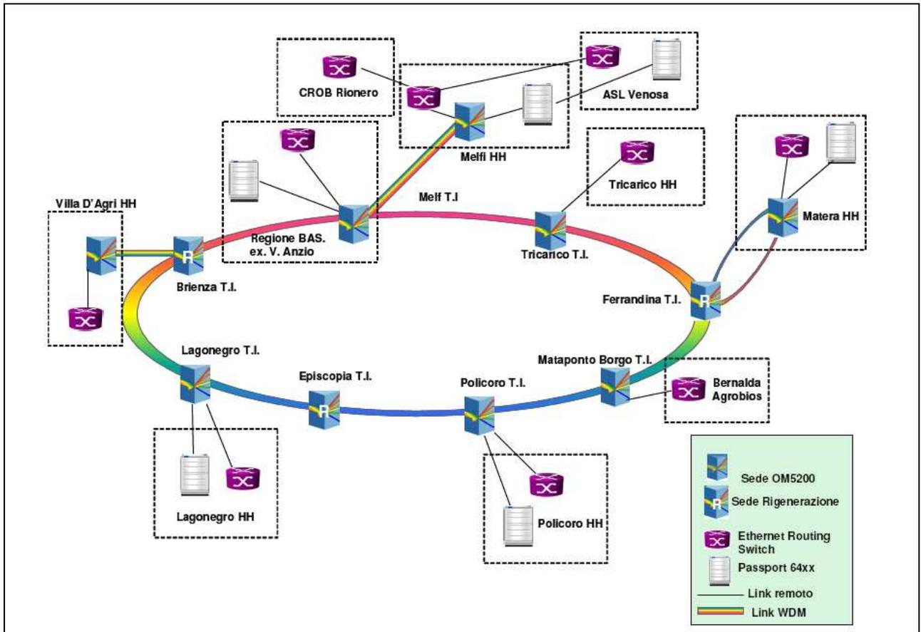
Figura 2.3: Topologia completa dei collegamenti core-backbone ottico
